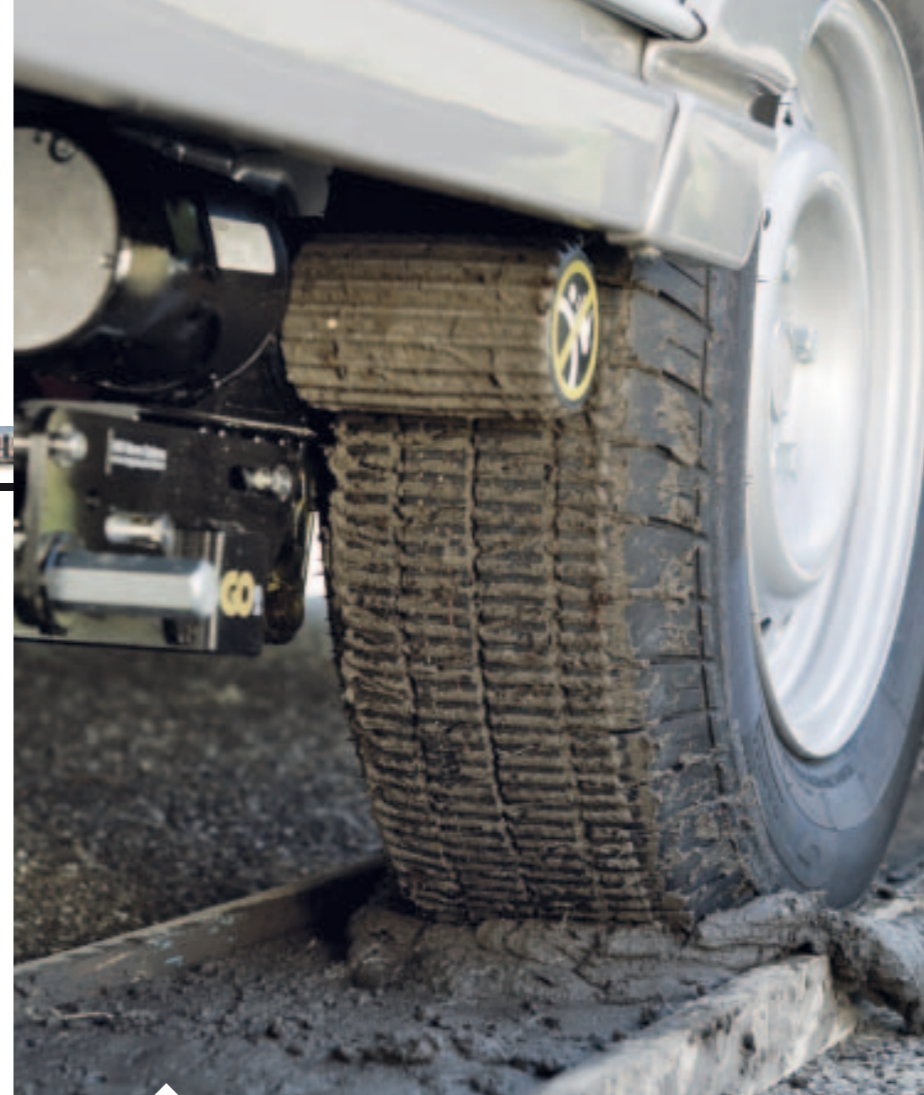
Een van de caravanwielen rijdt tijdens de test door een vijf meter lange modderbak. Zo wordt de mate van grip vastgesteld
